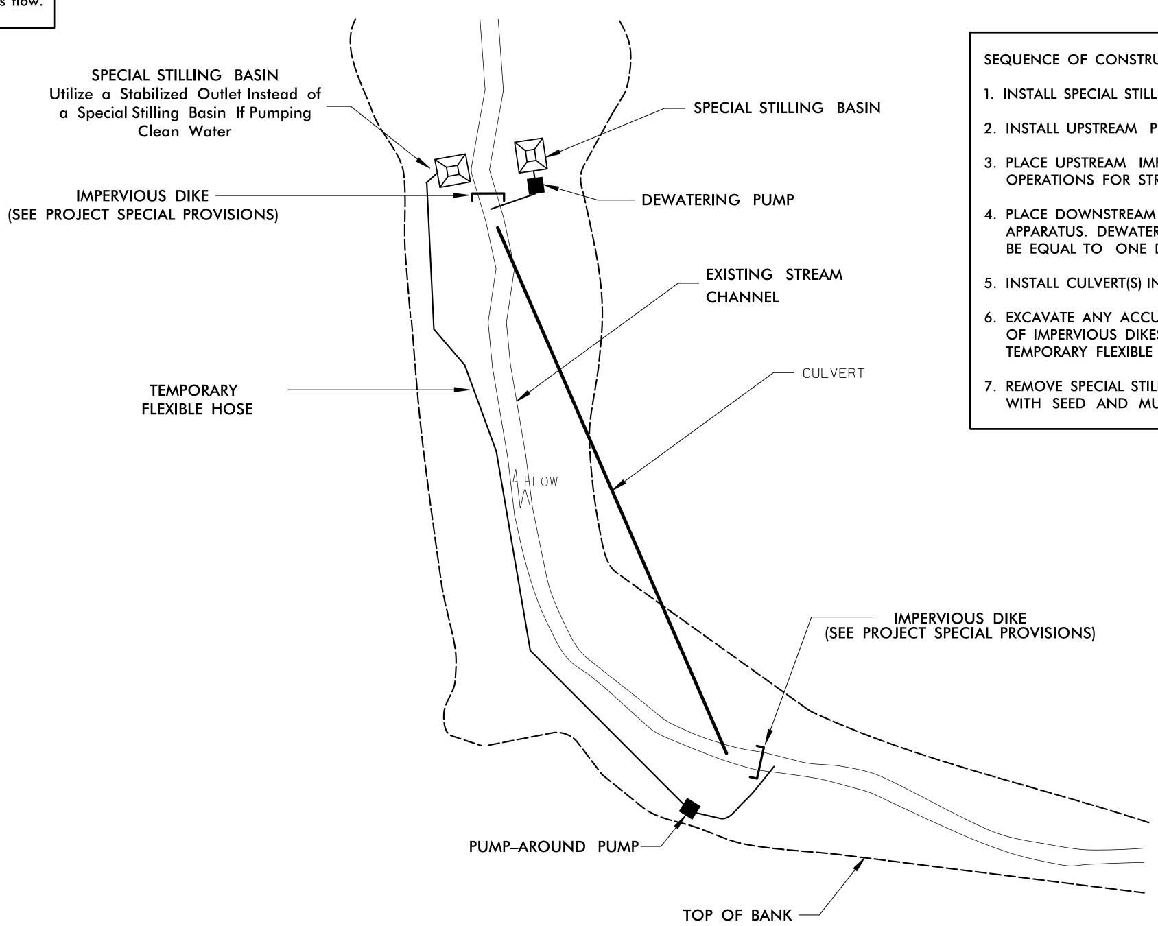
SEQUENCE OF CONSTRUCTION FOR TYPICAL WORK AREA
