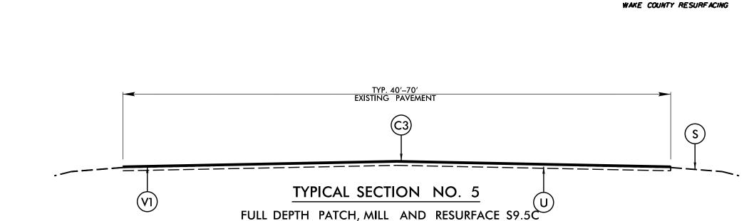
SHOULDERS ARE RECONSTRUCTED TO THE SHOULDER POINT/HINGE POST SEEDING AND MULCHING SHALL BE PERFORMED UPON COMPLETION OF SHOULDER GRADING WHEN EARTH BORROW IS USED
