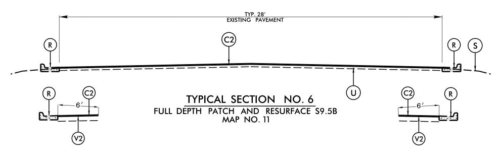
SHOULDERS ARE RECONSTRUCTED TO THE SHOULDER POINT/HINGE POST SEEDING AND MULCHING SHALL BE PERFORMED UPON COMPLETION OF SHOULDER GRADING WHEN EARTH BORROW IS USED
