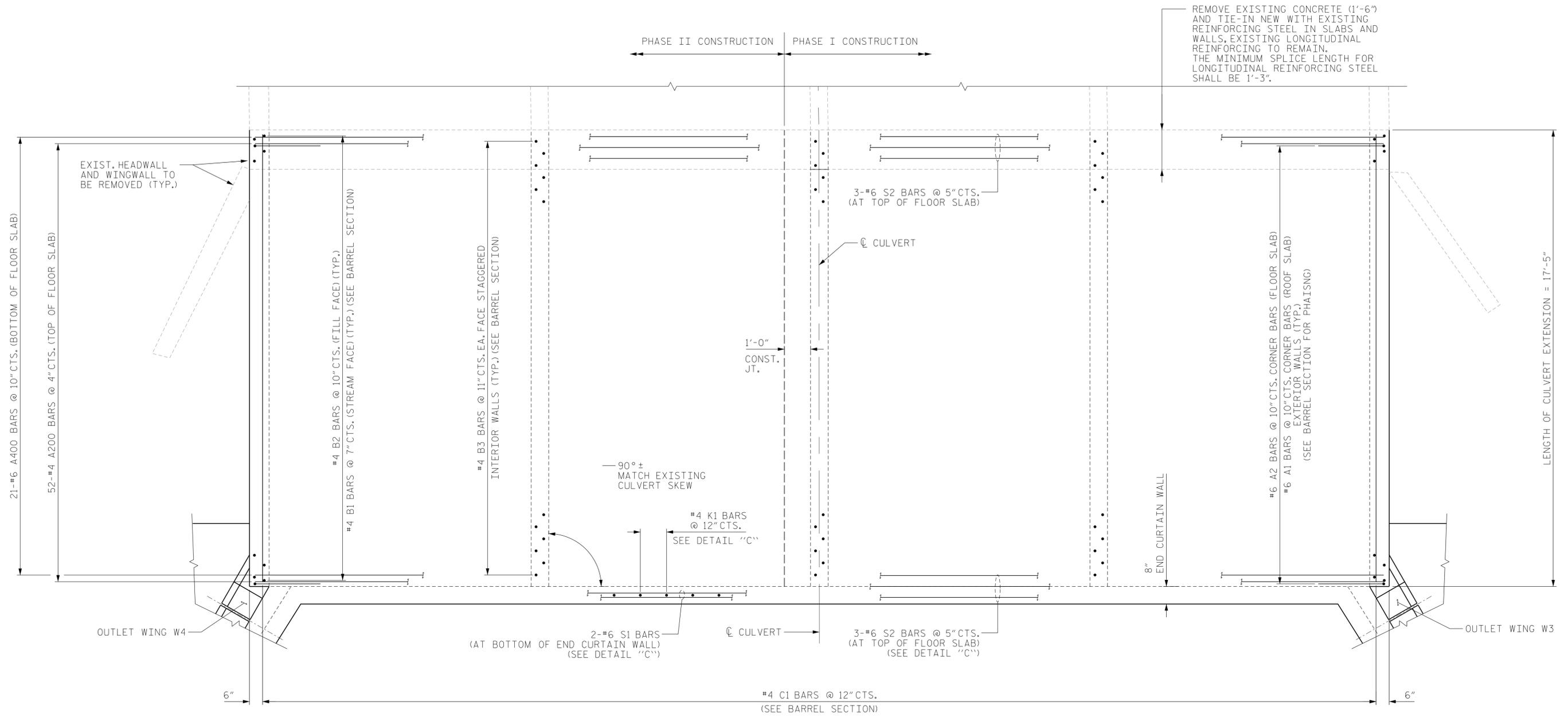
REMOVE EXISTING CONCRETE (1'-6") AND TIE-IN NEW WITH EXISTING REINFORCING STEEL IN SLABS AND WALLS, EXISTING LONGITUDINAL REINFORCING TO REMAIN. THE MINIMUM SPLICE LENGTH FOR LONGITUDINAL REINFORCING STEEL SHALL BE 1'-3".
