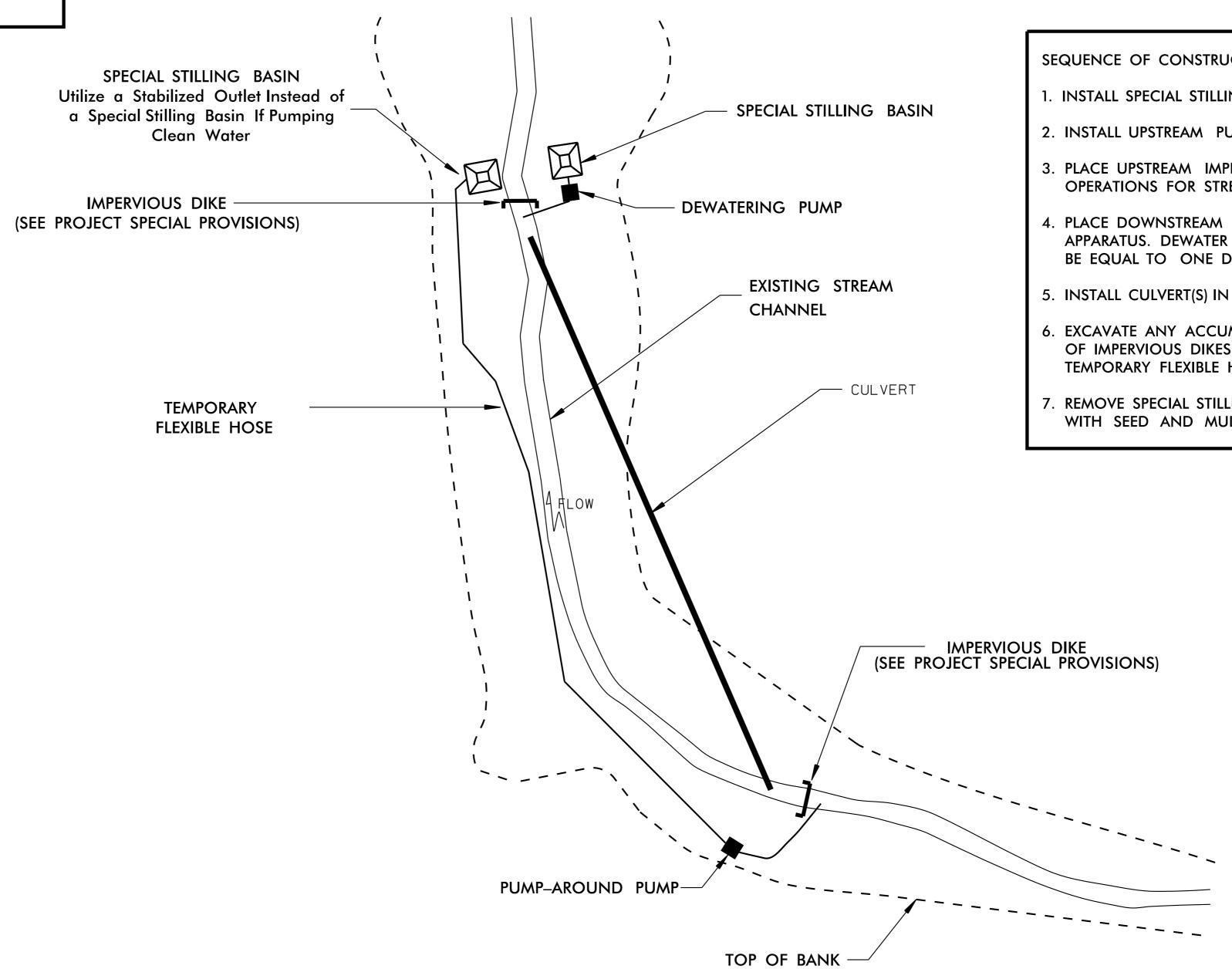
SEQUENCE OF CONSTRUCTION FOR TYPICAL WORK AREA
