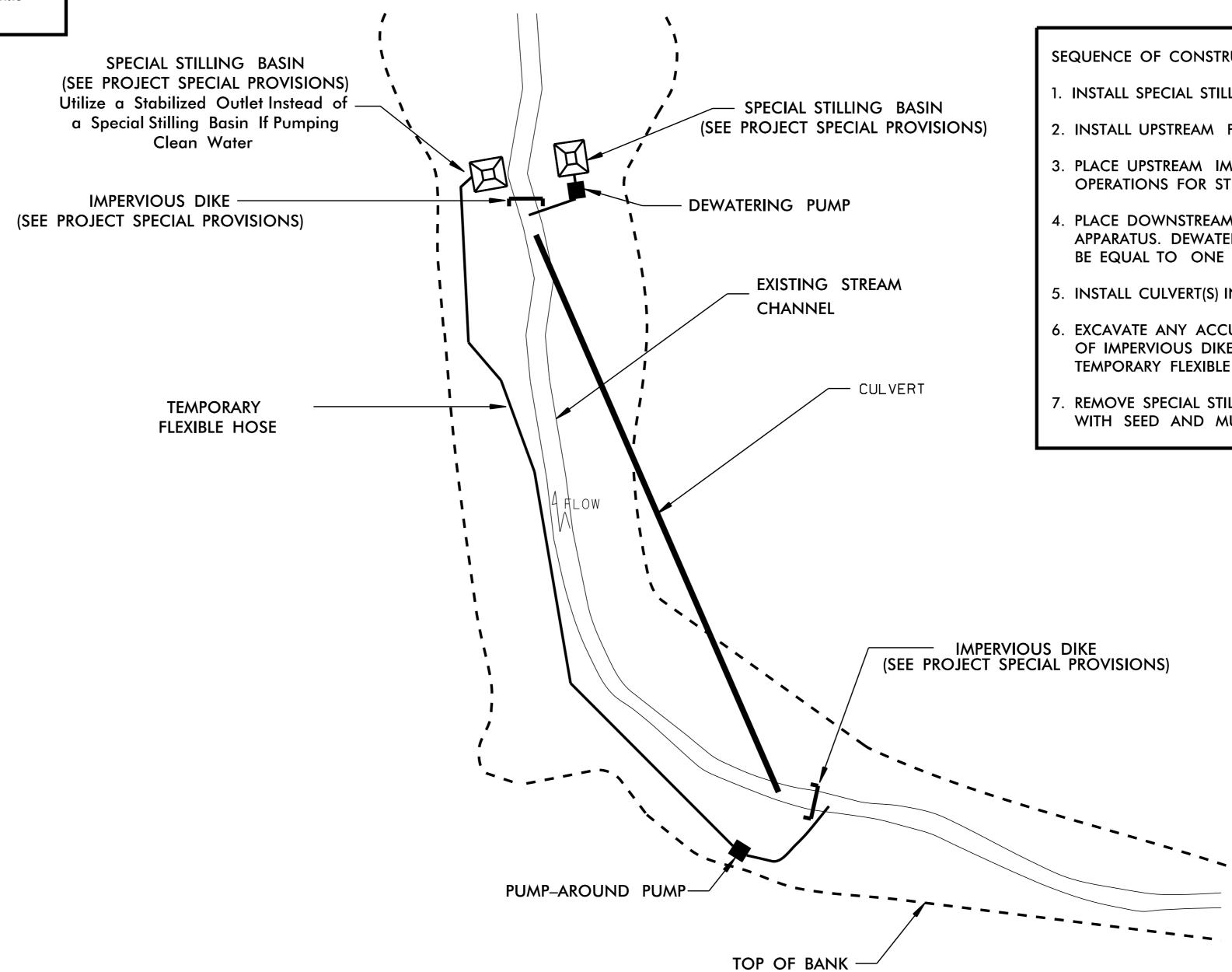
SEQUENCE OF CONSTRUCTION FOR TYPICAL WORK AREA
