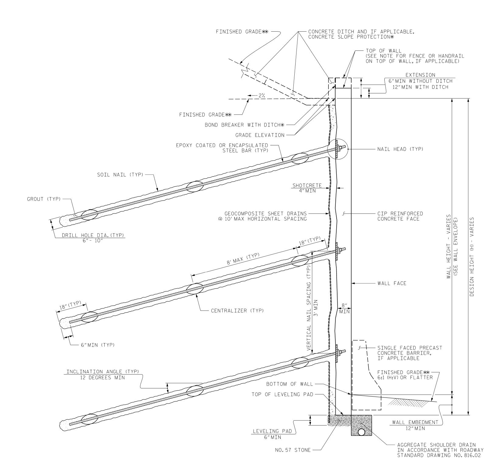
SOIL NAIL WALL - TYPICAL SECTION
