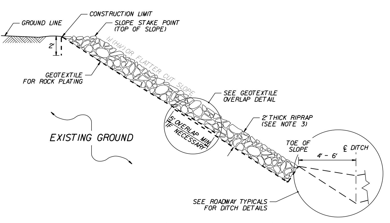
SPECIAL ROCK PLATING DETAIL - TYPICAL SECTION
