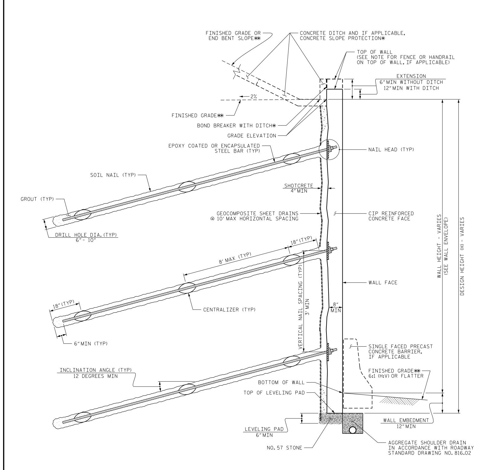
SOIL NAIL WALL - TYPICAL SECTION
