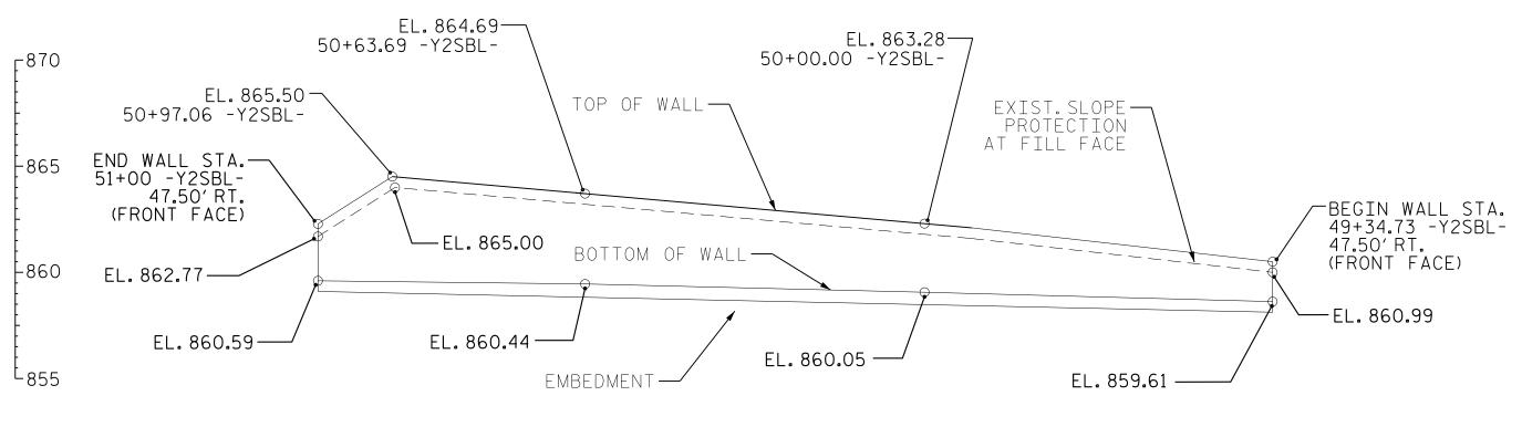
RETAINING WALL NO.7 - ELEVATION VIEW NTS
