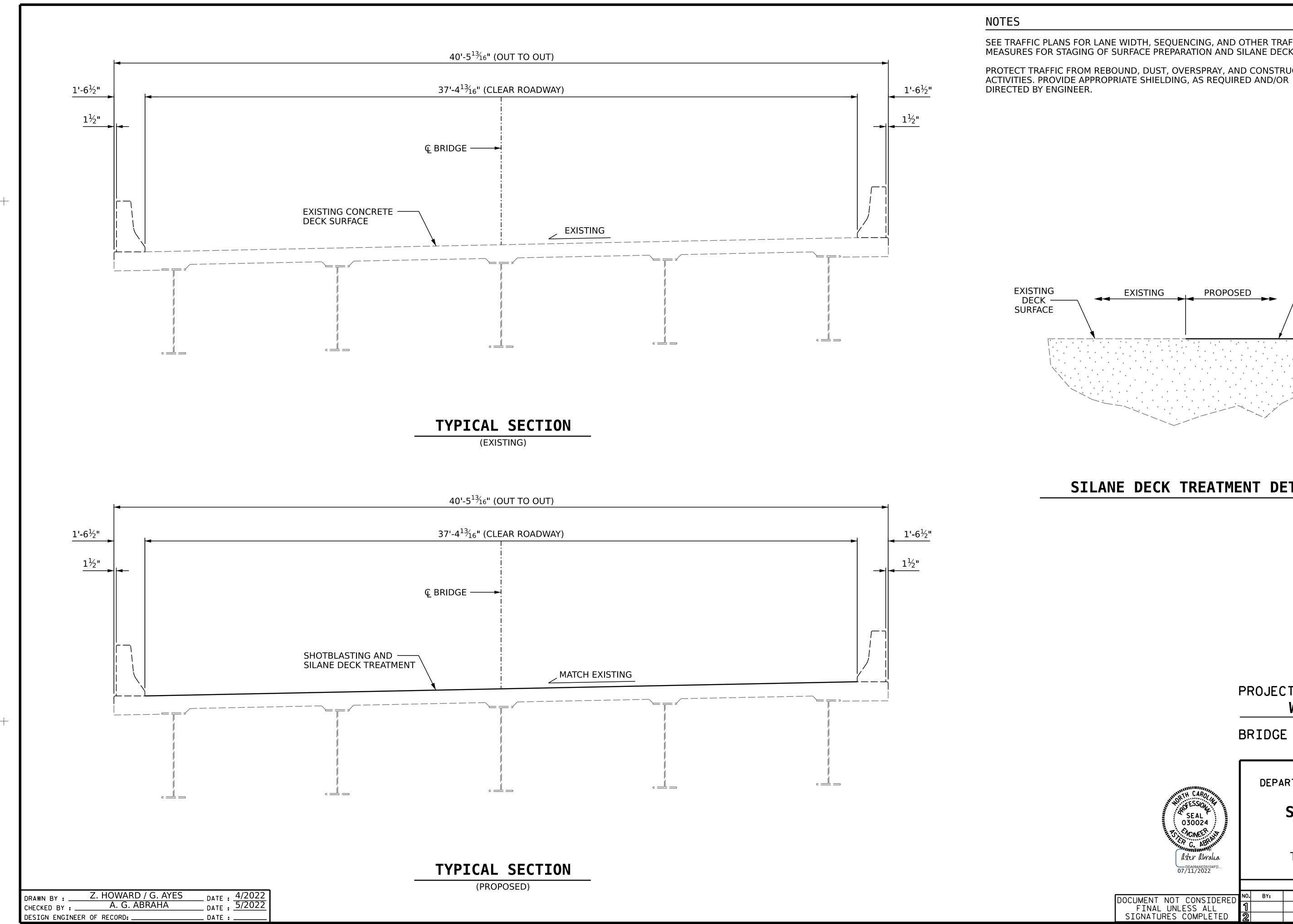
SEE TRAFFIC PLANS FOR LANE WIDTH, SEQUENCING, AND OTHER TRAFFIC CONTROL MEASURES FOR STAGING OF SURFACE PREPARATION AND SILANE DECK TREATMENT.
