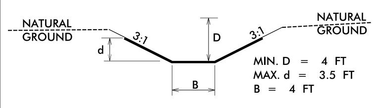
TYPE OF LINER = GEOTEXTILE FOR SOIL STABILIZATION
