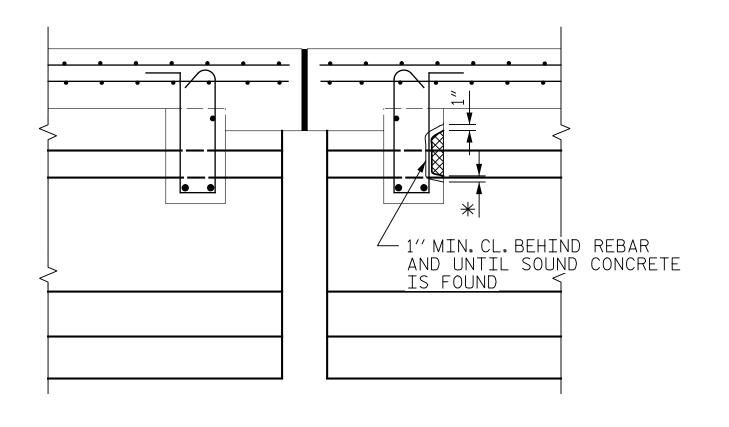
TYPICAL SECTION AT EXPANSION JOINTS
