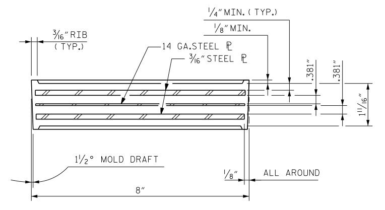
TYPICAL SECTION OF ELASTOMERIC BEARINGS
