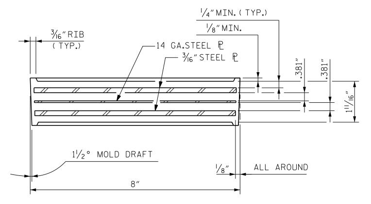
TYPICAL SECTION OF ELASTOMERIC BEARINGS
