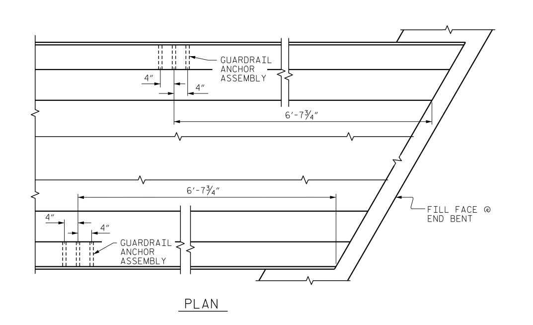
LOCATION OF ANCHORS FOR GUARDRAIL
