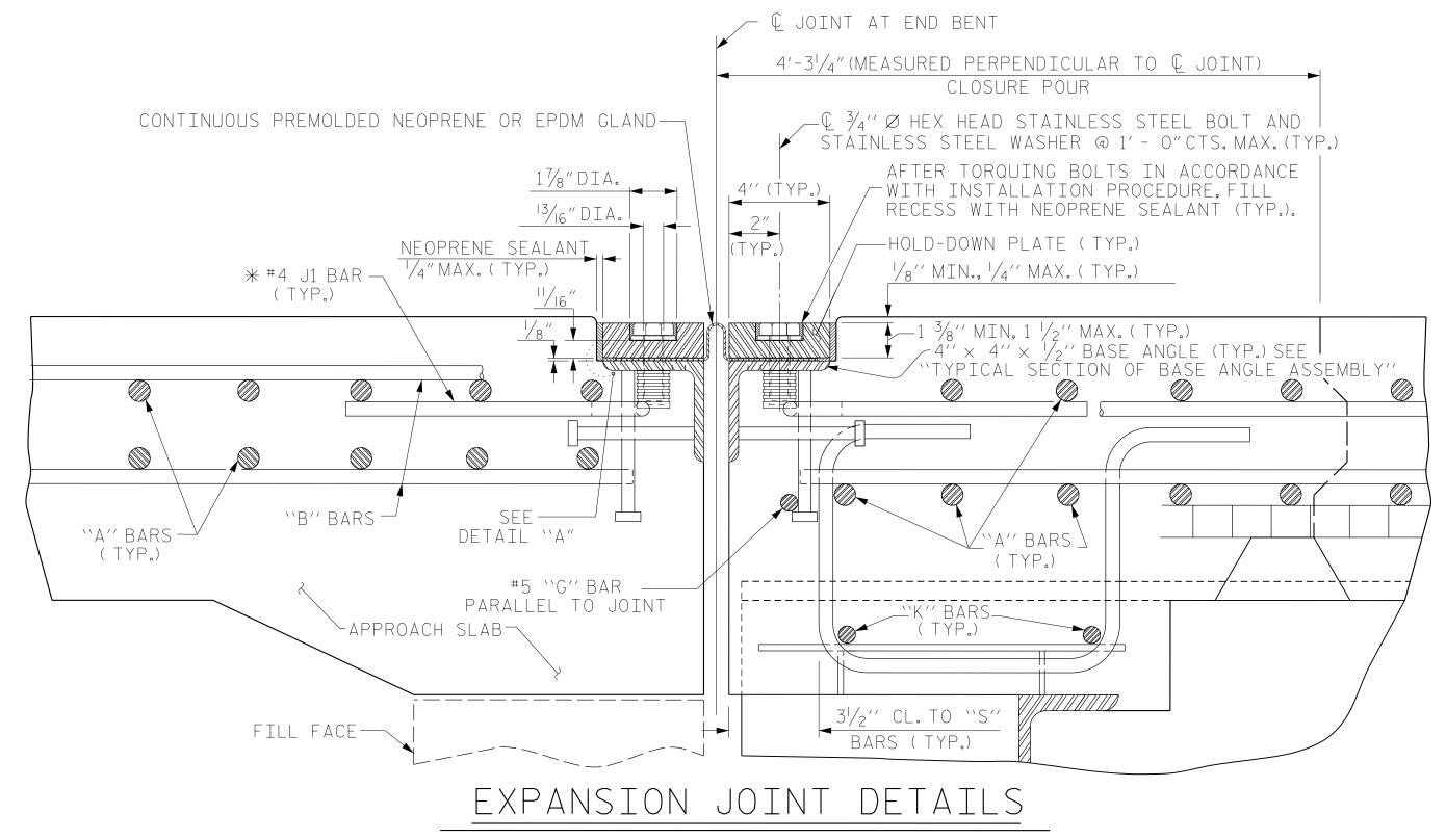
SECTION NORMAL TO JOINT -- STEEL SUPERSTRUCTURE
