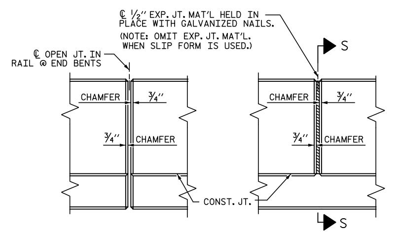
ELEVATION AT EXPANSION JOINTS BARRIER RAIL DETAILS
