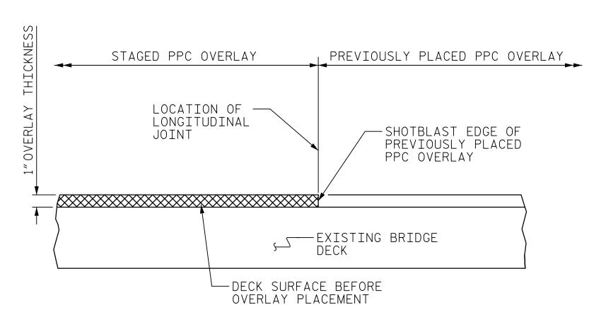
STAGED PPC OVERLAY JOINT
