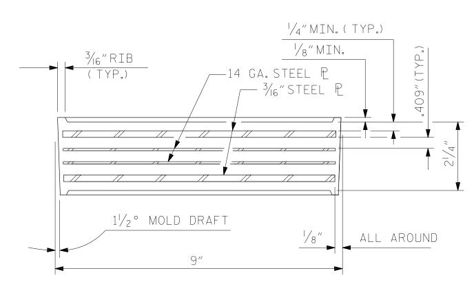
TYPICAL SECTION OF ELASTOMERIC BEARINGS
