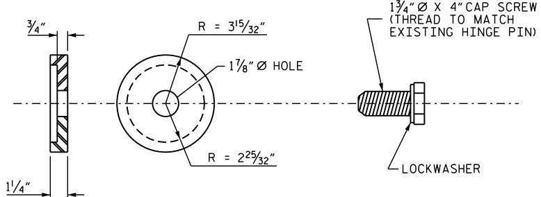
HINGE PIN CAP SCREW & PLATE DETAIL
