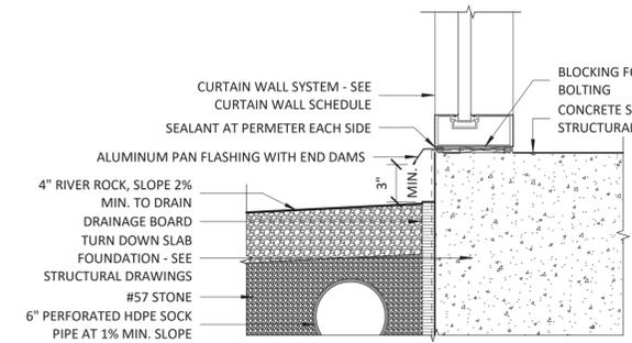
**6 SILL - CURTAIN WALL @ EXTERIOR SLAB**
