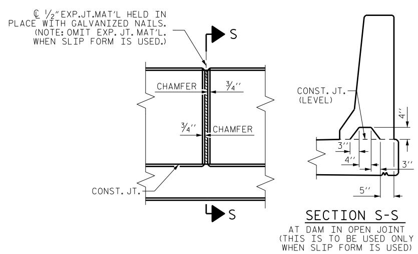
ELEVATION AT EXPANSION JOINTS BARRIER RAIL DETAILS
