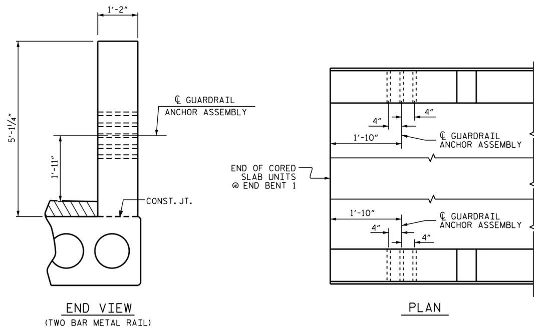
**LOCATION OF GUARDRAIL ANCHOR AT END POST**
