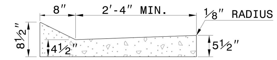
**MODIFIED SHOULDER BERM GUTTER**
