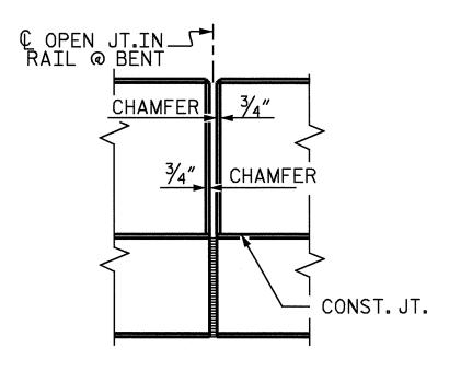
ELEVATION AT EXPANSION JOINTS
