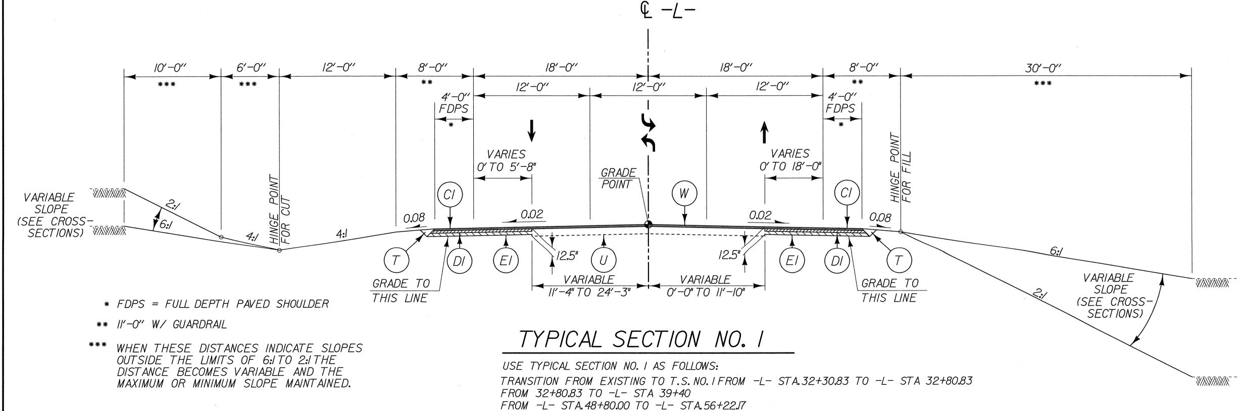
TRANSITION FROM T.S.NO. I TO EXISTING FROM -L- STA. 56+22.17 TO -L- STA. 56+72.17
