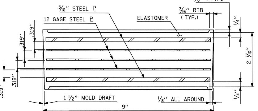
TYPICAL SECTION OF ELASTOMERIC BEARINGS
