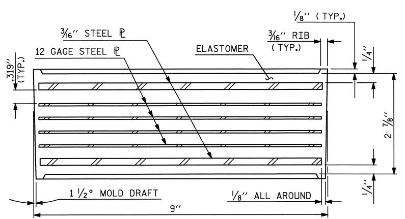
TYPICAL SECTION OF ELASTOMERIC BEARINGS
