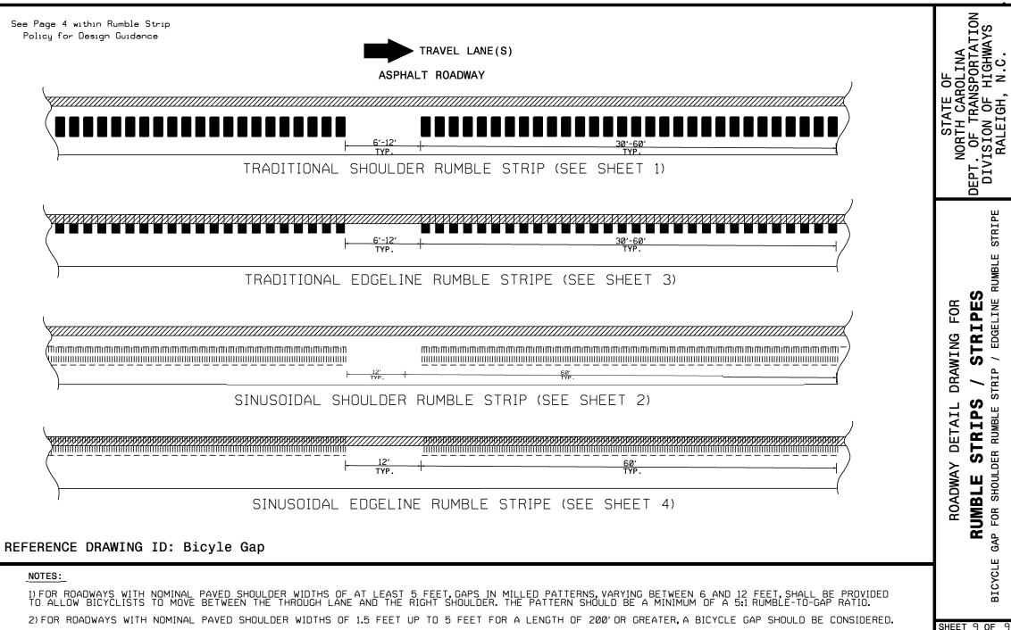
3) FOR ROADWAYS WITH NOMINAL PAVED SHOULDER WIDTHS OF LESS THAN 1.5 FEET, NO BICYCLE GAP IS NEEDED.
