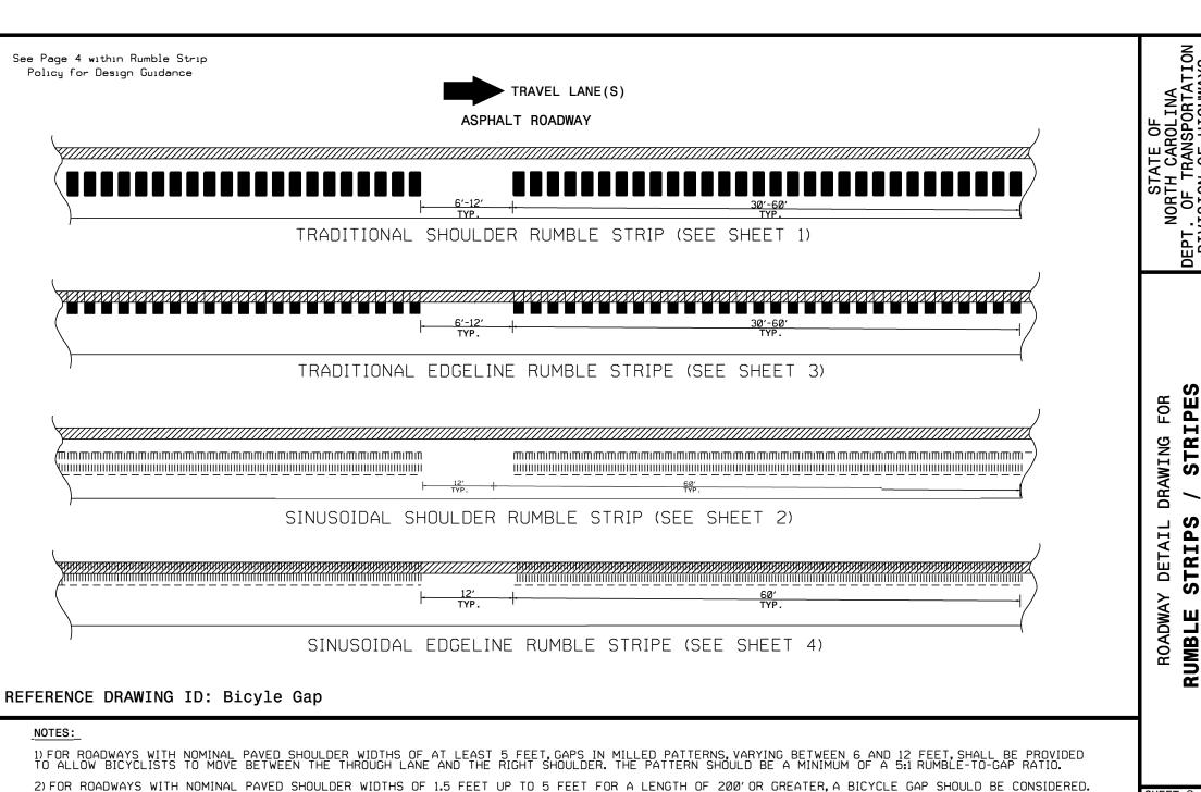
3) FOR ROADWAYS WITH NOMINAL PAVED SHOULDER WIDTHS OF LESS THAN 1.5 FEET, NO BICYCLE GAP IS NEEDED.
