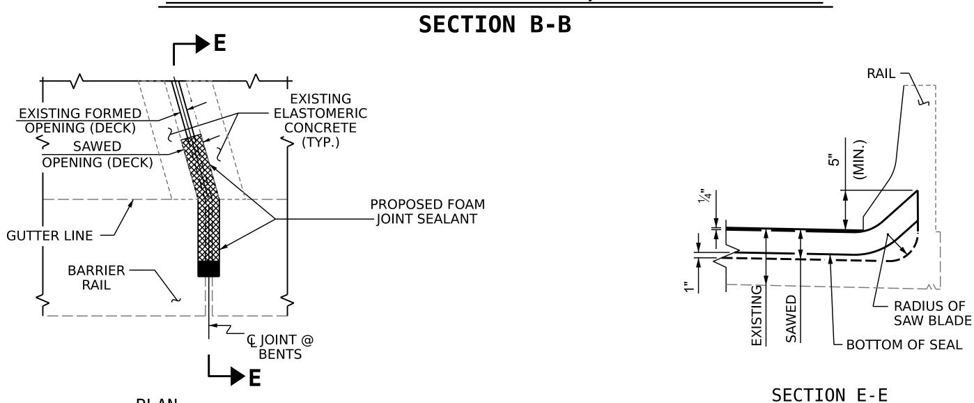
JOINT DETAIL AT BARRIER RAIL
