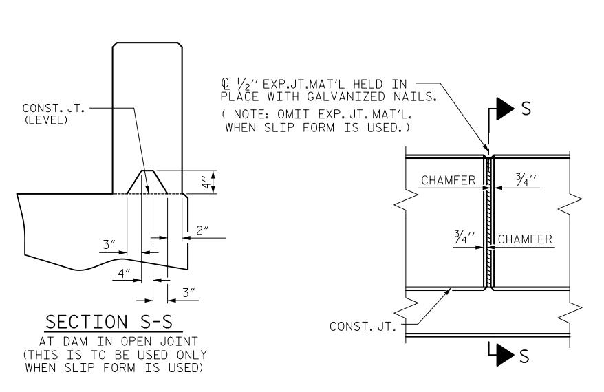
ELEVATION AT JOINTS IN PARAPET
