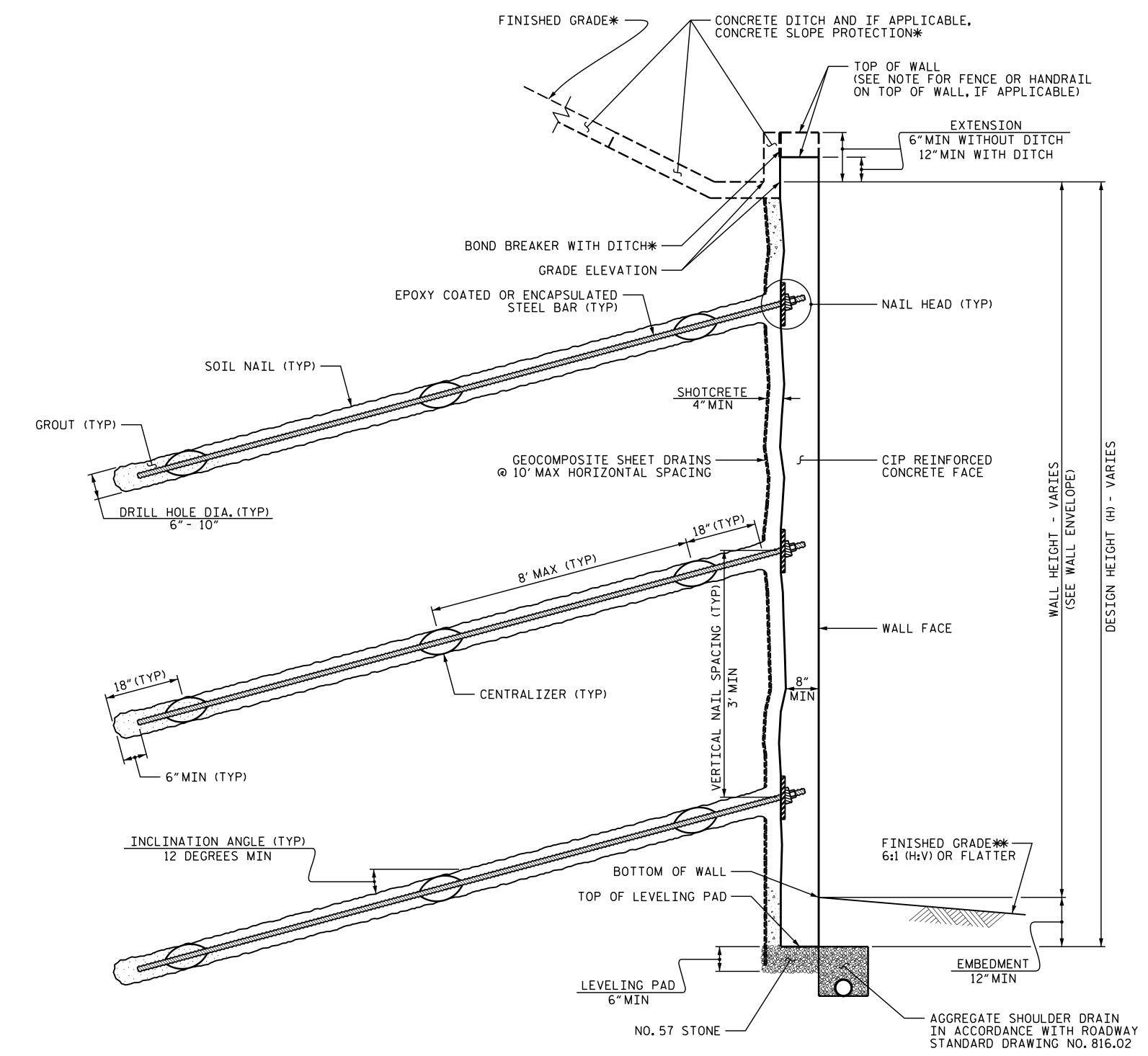
SOIL NAIL WALL (RETAINING WALL NO.3) - TYPICAL SECTION
