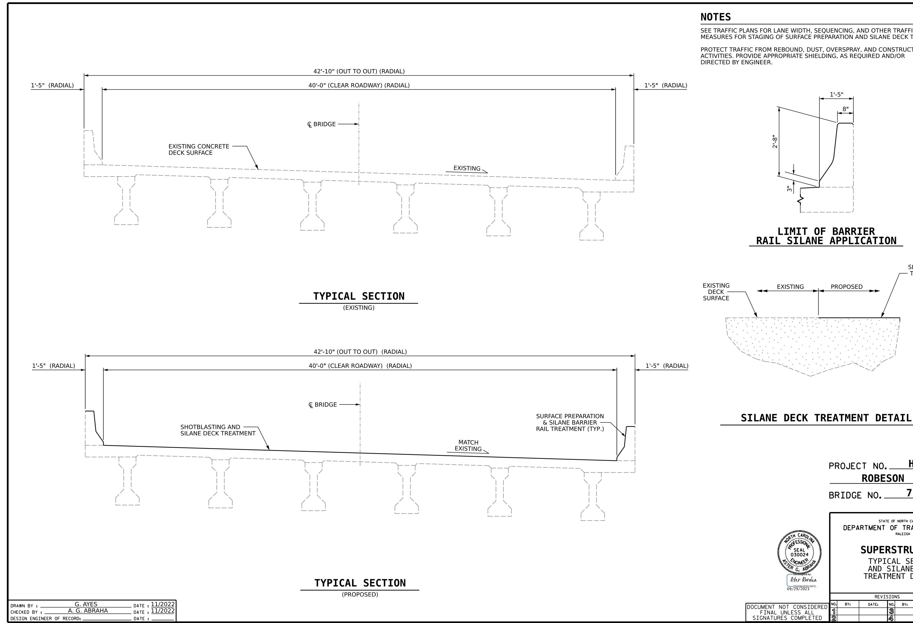
SEE TRAFFIC PLANS FOR LANE WIDTH, SEQUENCING, AND OTHER TRAFFIC CONTROL MEASURES FOR STAGING OF SURFACE PREPARATION AND SILANE DECK TREATMENT.
