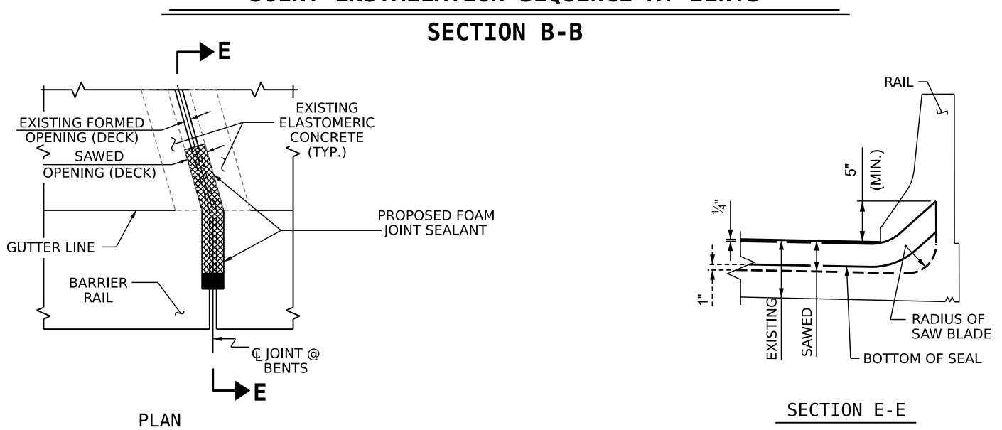
JOINT DETAIL AT BARRIER RAIL
