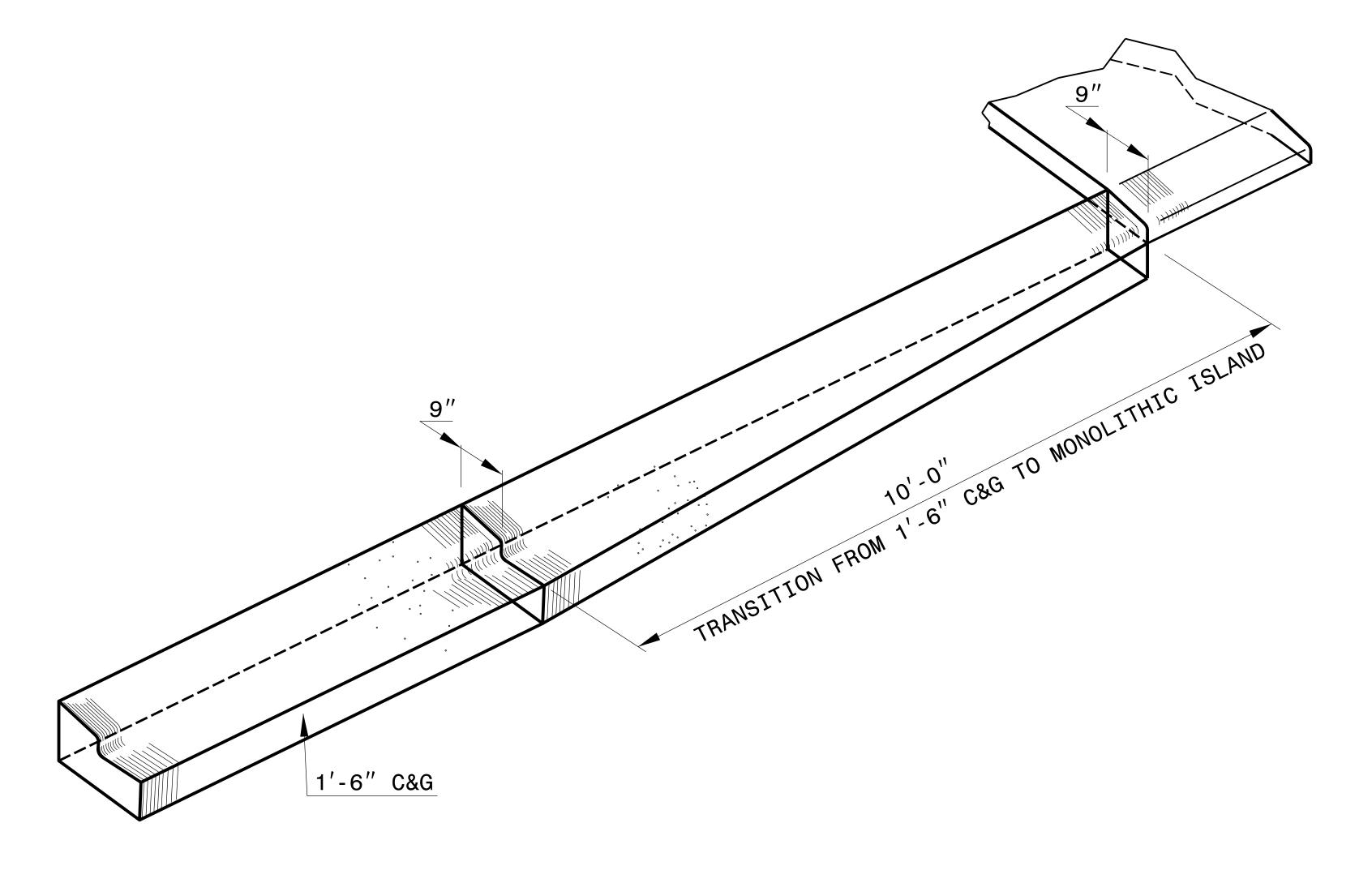
ISOMETRIC VIEW OF TRANSITIONING CURB & GUTTER
