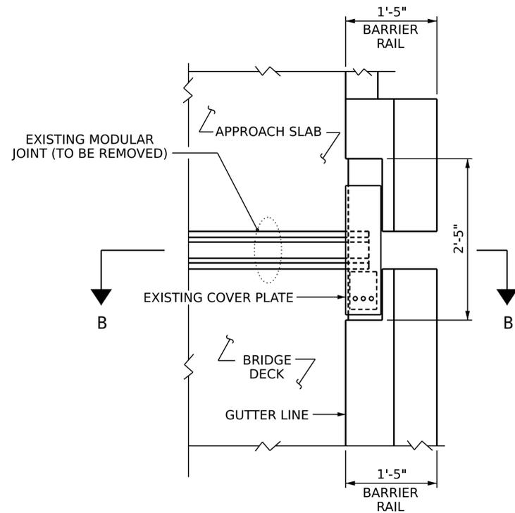
PLAN OF EXISTING MODULAR EXPANSION JOINT SEAL
