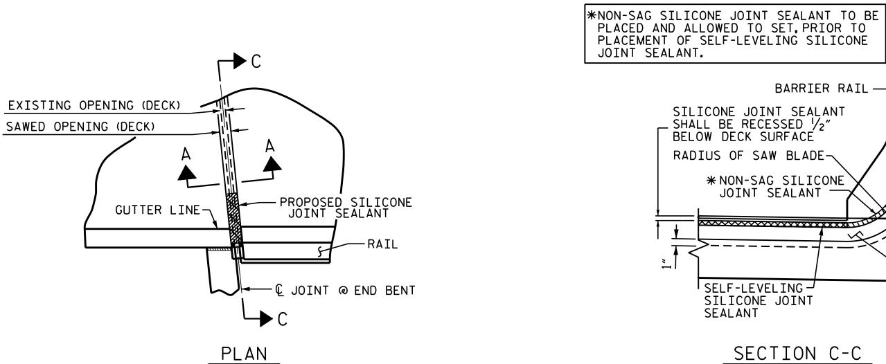
JOINT DETAILS AT BARRIER RAIL
