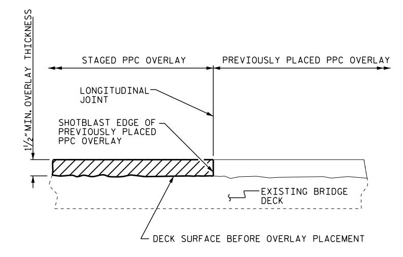
STAGED PPC OVERLAY JOINT
