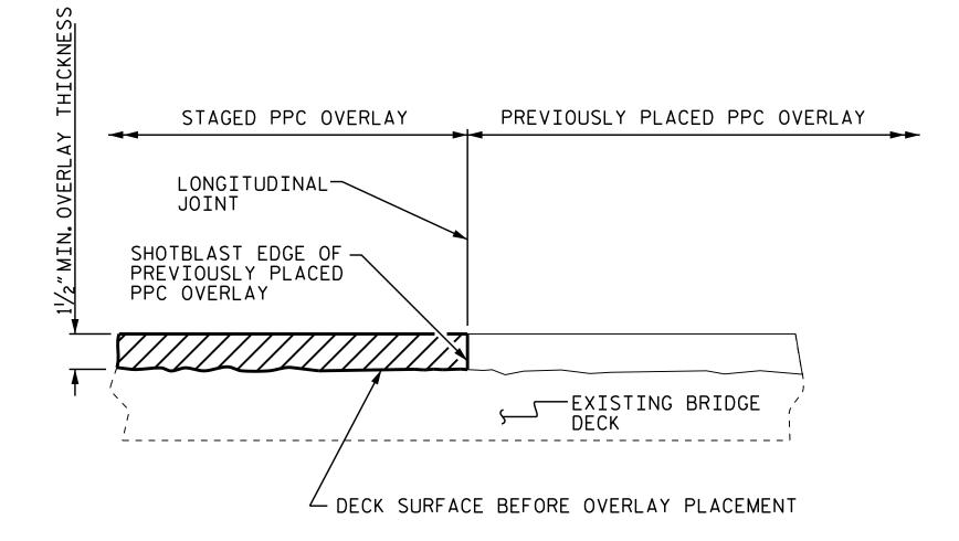
STAGED PPC OVERLAY JOINT
