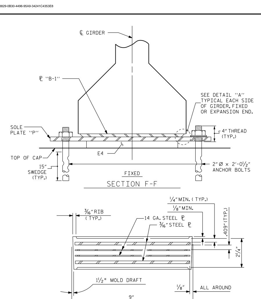
TYPICAL SECTION OF ELASTOMERIC BEARINGS
