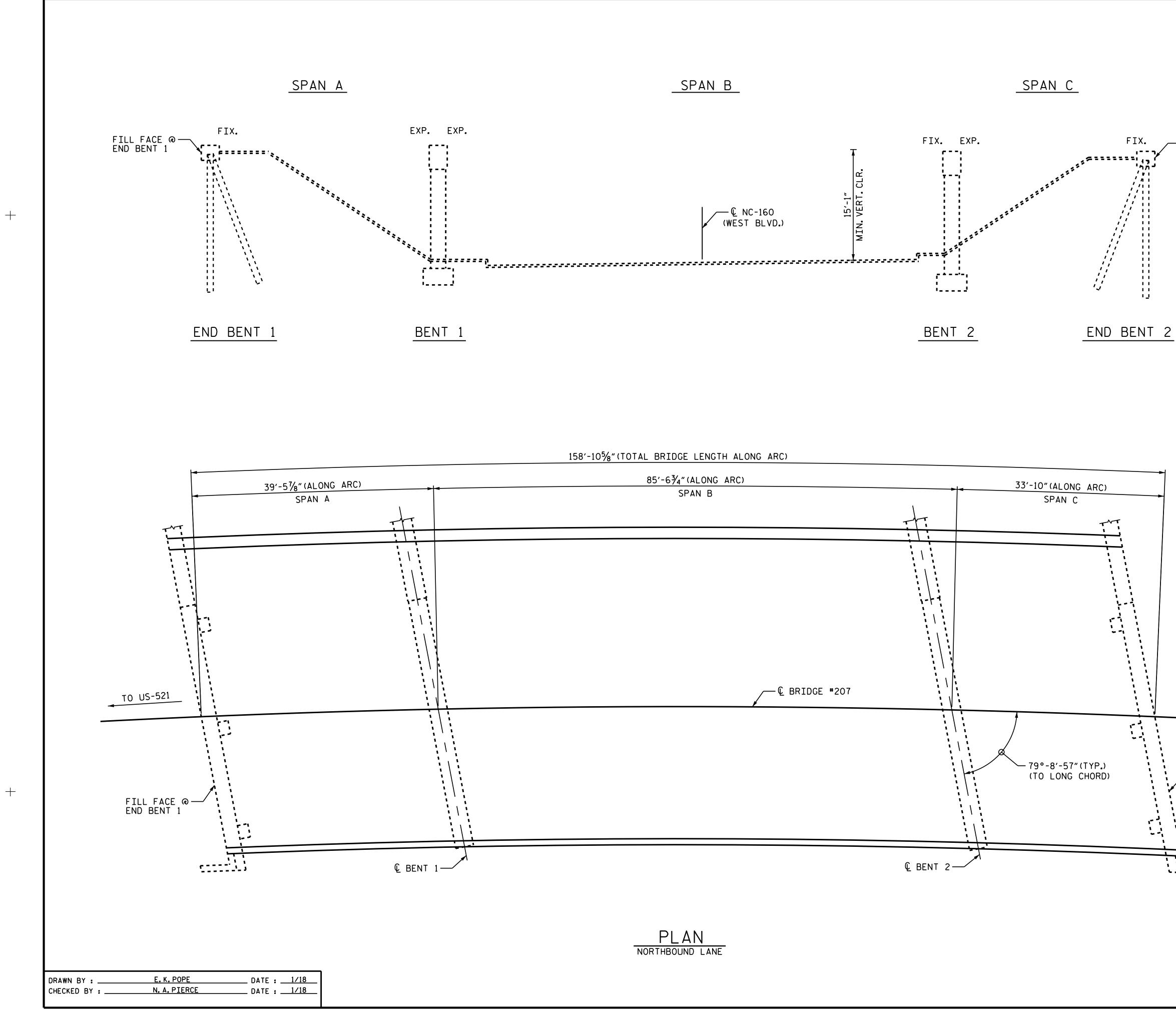
NOTES PROFILE INFOMATION IS TAKEN FROM THE ORIGINAL PLANS, THE WIDENING PLANS AND THE ROUTINE INSPECTION REPORT DATED 10/25/2016. BRIDGE ORIENTATION CONFORMS TO EXISTING BRIDGE PLANS.
