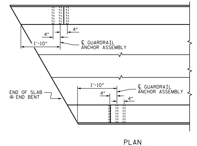
LOCATION OF ANCHORS FOR GUARDRAIL
