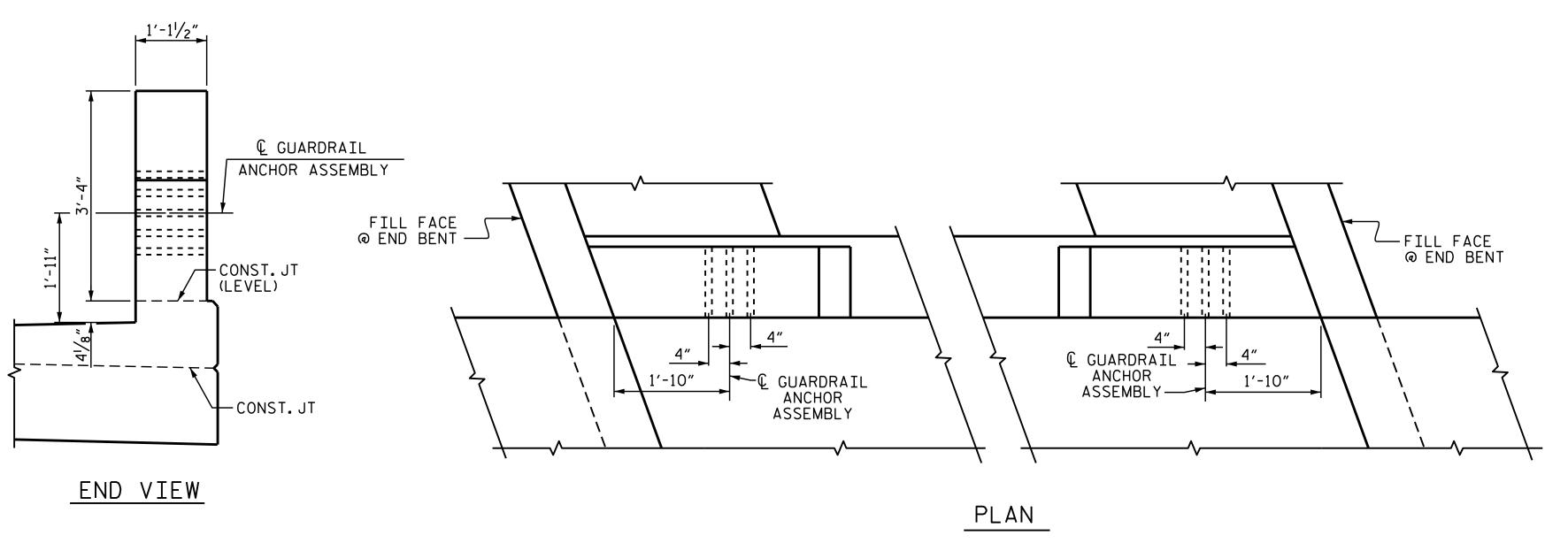
LOCATION OF ANCHORS FOR GUARDRAIL
