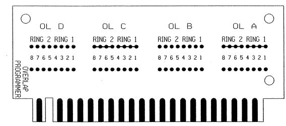
OVERLAP CARD SHALL BE COMPLETELY BLANK (NO OVERLAPS)
